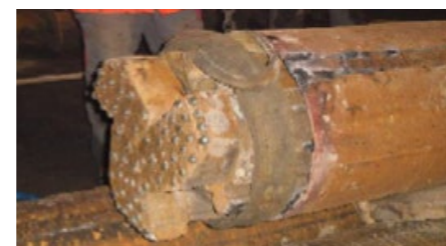
Tête de foreuse à marteau fond de trou utilisée pour pousser les galets – Crédit photo euNetworks
